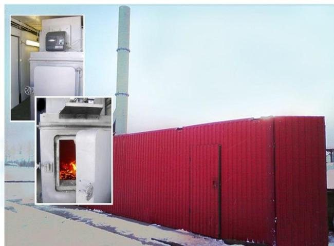
Транспортируемый комплекс термического обезвреживания отходов КТО-120К40Мед - в габаритах 40-фт. контейнера (120 кг/час)
