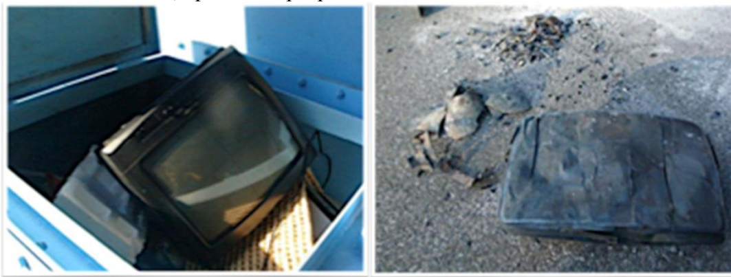
Рис. 4. Результат работы установки MAGMA-CMR для смешанных отходов.
